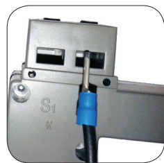
Capocorda a puntale dal lato P2 della custodia
